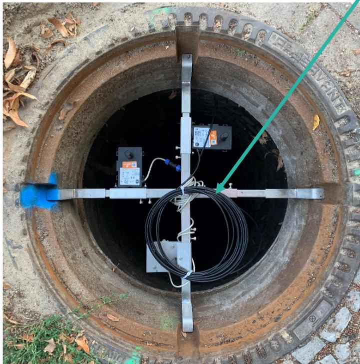
*Sendeeinheiten und Radar/Ultraschallsonde am Schachtkreuz direkt über Kanalmitte, Drucksonde auf 2/3 Höhe des Kanalquerschnitts verbaut.*
