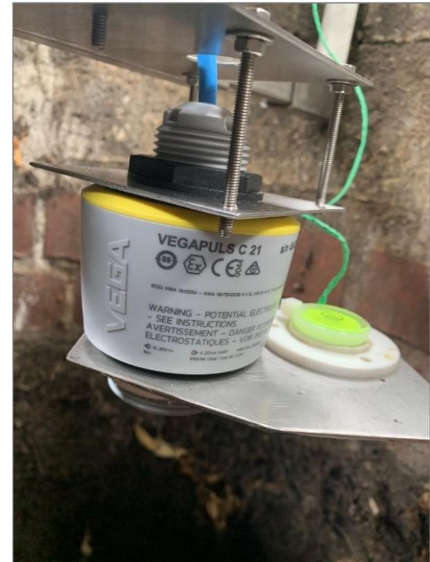
*v.l.n.r.: Kalibrieren der Drucksonde mit Wasserstand / Einmessen mittels Referenzhorizonts / Ausrichtung Radarsonde*
