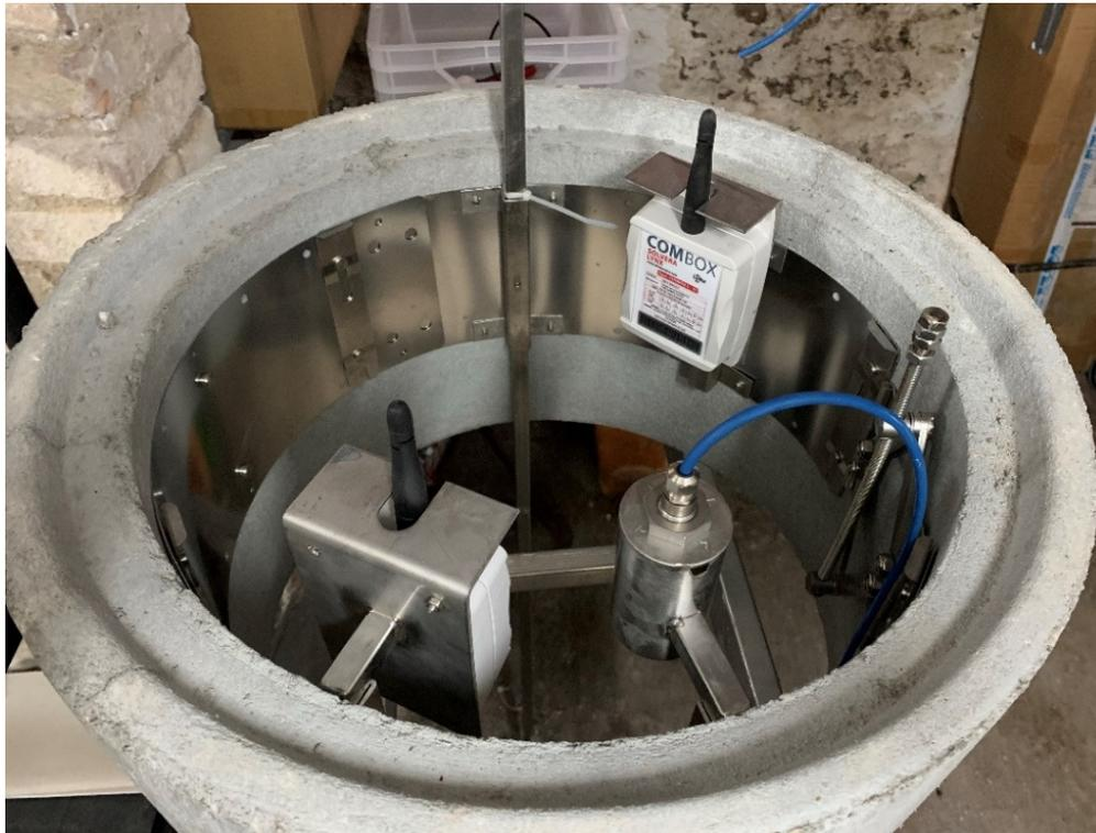
*Probeaufbau des Spannrings und Sensorik in einem genormten Straßenablauf-Betonring.*
