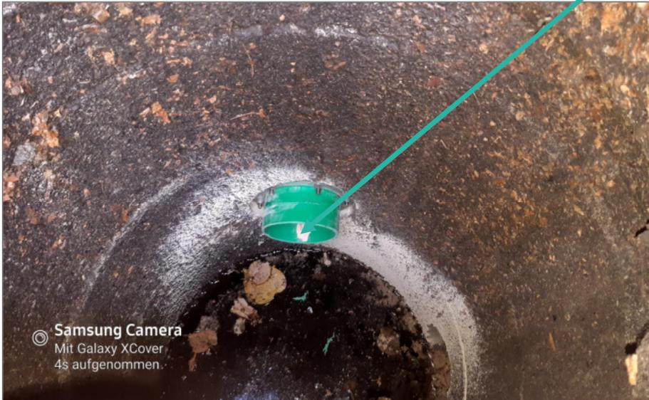
Anschluss an Straßenablauf → Wasserstand auf Straße „beruhigt“ in Rohr abgebildet
