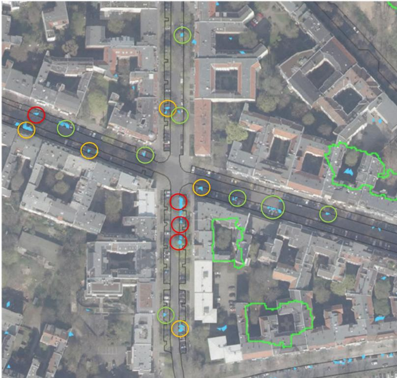
*Erste oberflächliche Überflutungen bei Belastung des Modells mit einem künstlichen Regenereignis (rot=relevant; grün=weniger relevant)*
