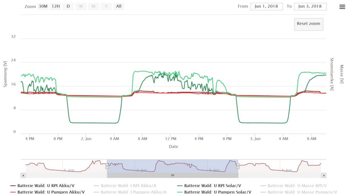
Abbildung 11: Vergleich des Regelverhaltens zweier Solarregler im Wald.
