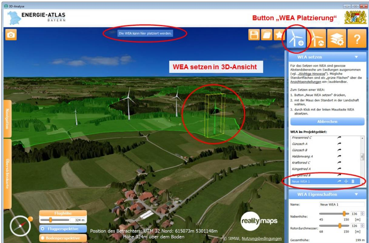
Abbildung 12: Setzen einer Windenergieanlage in der 3D-Ansicht
